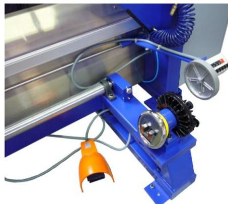
**Klapplager mit Scheibenbremse,
